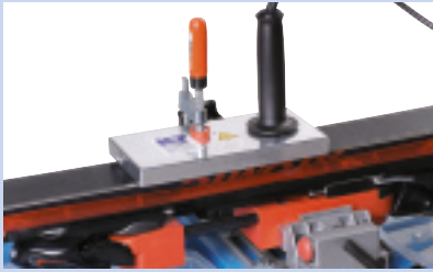
vorwärmen des Belags
