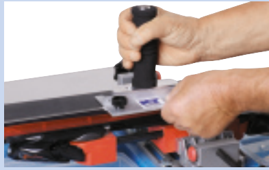
Abstandseinstellung zur Stahlkante
