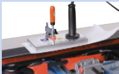
einkleben des Stanzprofils mittels Heizplatte und Trennpapier
